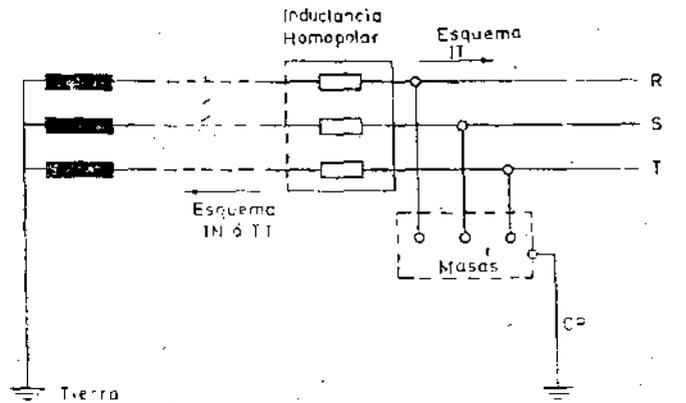
Fig. 9 Esquema IT en Serie con un Esquema TN o IT
