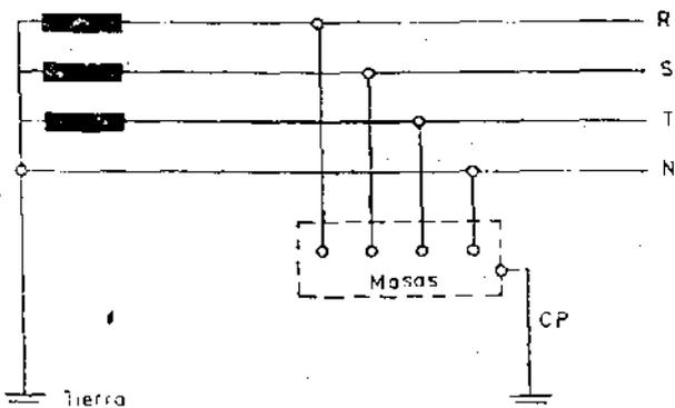
Fig. 6 Esquema TT
